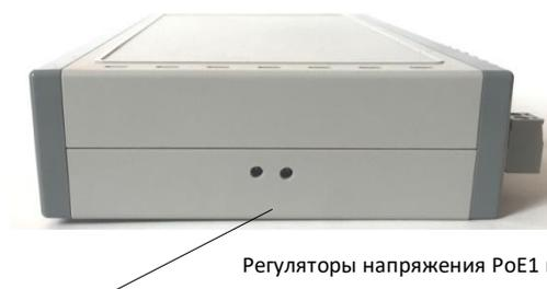
**Внимание! Будьте предельно внимательны при регулировке напряжения PoE! Убедитесь, что питаемое устройство поддерживает установленное напряжение питания! При эксплуатации необходимо соблюдать "Правила технической эксплуатации и правила техники безопасности для электроустановок до 1000В". Монтаж должен осуществляться квалифицированным специалистом.**
